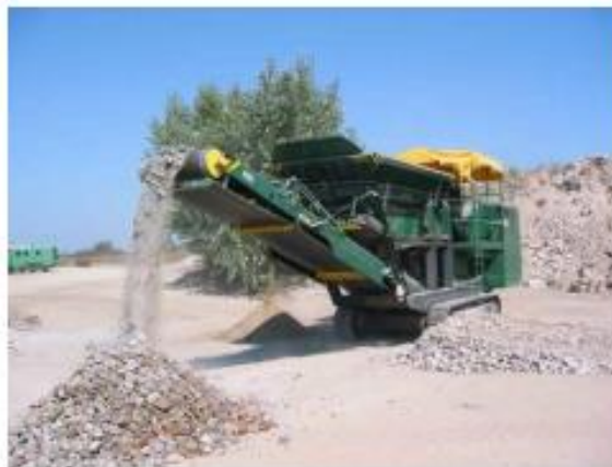
Obr. 3.6 Mobilní drtící jednotka PSP MDJ ODR 900x1000 na pásovém podvozku, zdroj [8]
